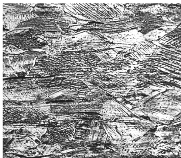
Aço inoxidável AISI 301 laminada a frio com 10% de redução (1/4 duro). Microestrutura constituída por matriz de austenita e martensita formada por deformação.
