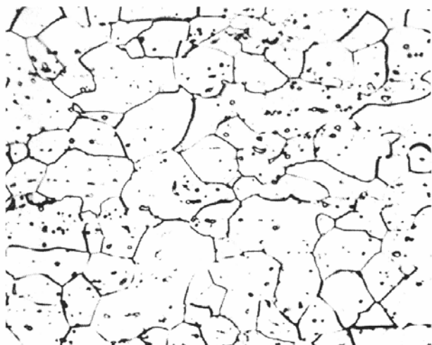
Aço inoxidável ferrítico AISI 430 recozido a 845°C . 500X Microestrutura constituída por matriz ferrítica e dispersão de carbonetos de cromo.
