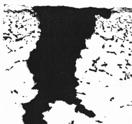
Sem ataque Pite em aço inoxidável AISI 302 sujeito a um meio contendo cloretos.
