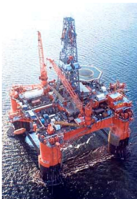
Figura 6.5 - Sonda semi-submersível – utilizada para perfuração em lâminas d'água profunda.
