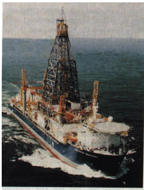
Figura 6.4 - Navio sonda – torre de perfuração montada no deck de um navio que tem todos os equipamentos para perfuração de poços de petróleo
