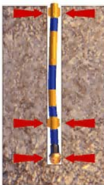
Figura – Ação do estabilizador na parede
